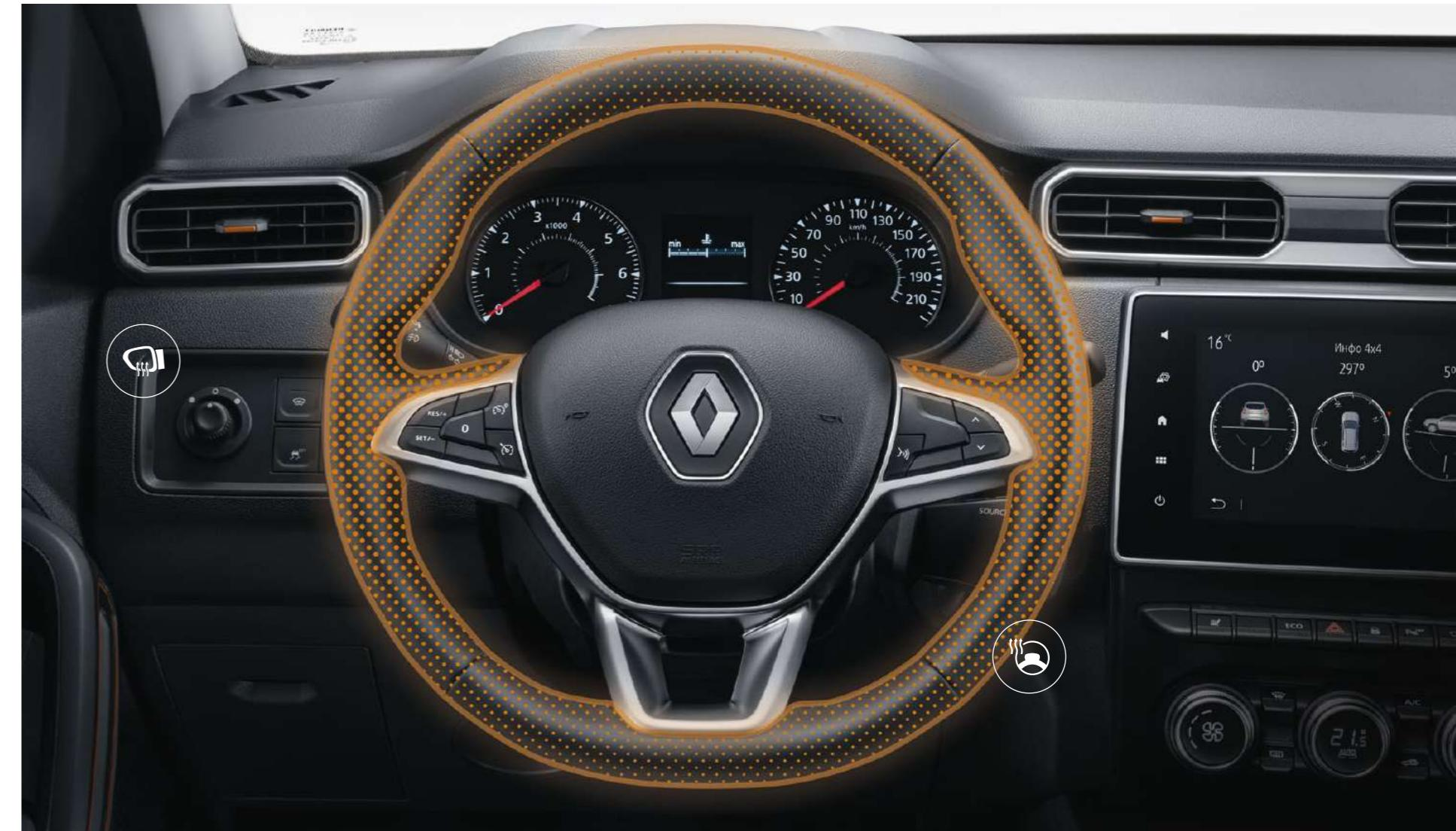
Среди опций для холодного времени года теперь есть не только подогрев передних сидений и электрообогрев лобового стекла. К ним добавились обогрев рулевого колеса, двухступенчатый подогрев задних сидений, а также подогрев форсунок стеклоомывателя.
