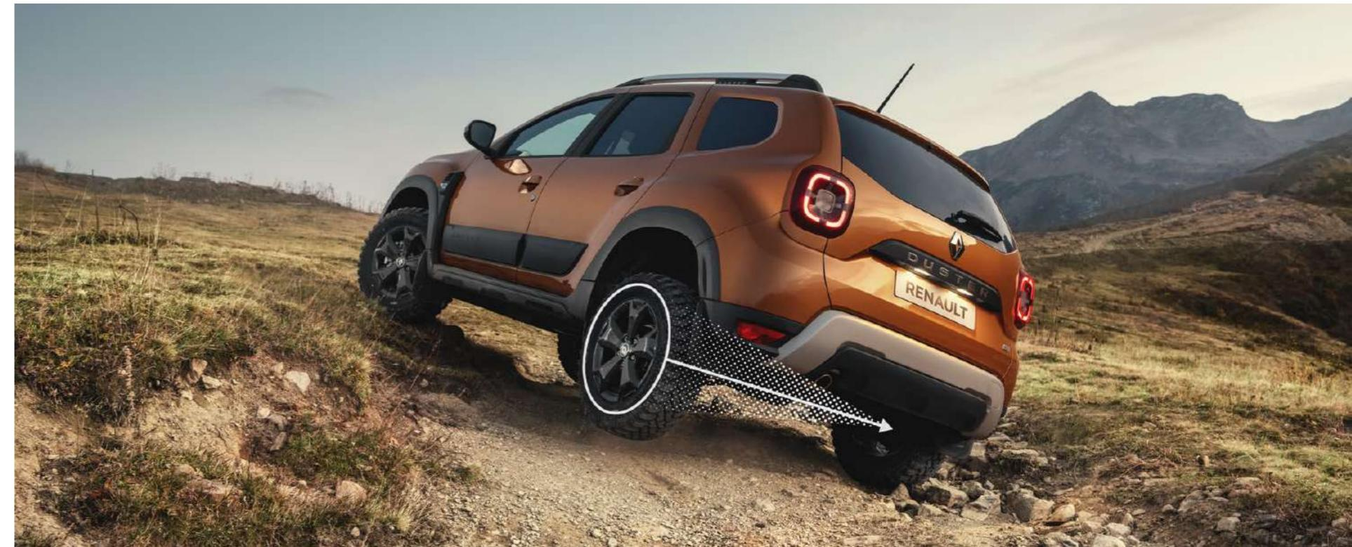
Алгоритм перераспределения крутящего момента между колесами обеспечивает оптимальное сцепление всех колес с любым типом покрытия, выполняя функцию блокировок межколесных дифференциалов.
